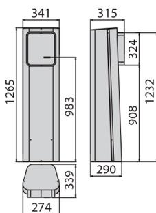
La estación Espas 20-I, combinada con una barrera electromecánica y un par de espiras, permite controlar la entrada a un aparcamiento. El sistema funciona de modo autónomo, sin necesidad de cables entre los diversos elementos del aparcamiento.
